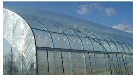
二重被覆した農POフィルムの中間に空気を送風して空気膜層を作ることができるフィルムです。既存のパイプハウスに被覆することができ、暖房費の20~30%節減が可能です。
