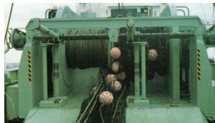
トロール操業の省人省力化を図る漁撈装置です。甲板作業の簡素化と自動化を追求し、さらに自動化を進めた「オートテンションウインチ」などの漁撈システムを提案しています。
