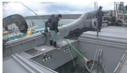
油圧・電動ウインチなどを作業者の「声」で操作できます。漁船漁業における省人省力化を実現できます。網漁業における揚網時の巻き込み事故等を防ぐ安全装置としても機能を発揮します。
