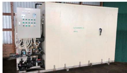
魚介類の冷却に最適な、高濃度海水シャーベット氷(微細氷と冷海水が混ざったもの)を作る装置です。適切に塩分濃度を調整した海水により対象魚に最適な氷を製造し、鮮度保持に貢献して水産物の価値を高めます。
