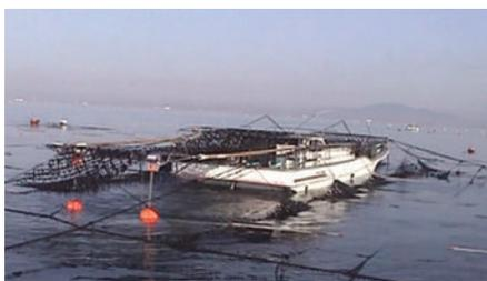
収納式レーダー、高性能GPSと特殊カメラ付テレビモニターを装備し、夜間の海苔の刈り取りと酸処理を可能にしました。一人で作業ができるため、厳冬の負担を軽くします。
