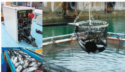
電気刺激により魚を鎮静化(暴れを抑制)し、魚の品質向上と活締め作業の労力軽減を実現できる「省力活魚取り扱いシステム」です。養殖業や定置網漁業で活用できます。タモ網式と作業台でのマット式があります。
