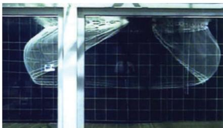
世界唯一のまき網・定置網用回流水槽で実験を行い、主に浮魚(アジ、サバ、イワシ、カツオ等)の魚群を網で囲い込むために最適な漁具を設計・製作しております。
