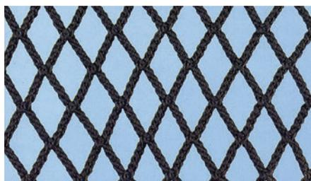
4本のストランドで組み紐状に編網された無結節網で、従来の蛙又網や無結節網にはない「高強力」「よれない」「摩擦に強い」「破れ難い」等の特徴を持ち、世界各国の漁場で使用されております。また、陸上でもスポーツ分野などに使用されております。
