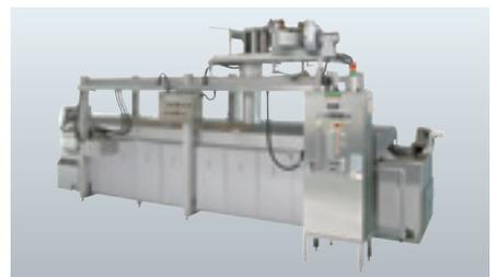
蒸気を熱源とした熱交換方式により、直火式に比べて熱効率がアップ、省エネ化を実現します。同時に火災の心配はなくなり、作業環境が大幅に改善されます。ガスを熱源とするガス熱交換式もあります。
