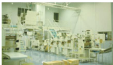
粉の投入、一定給水からミキサー、もみ打ち、麺帯の製造までの自動生麺製造システム。幅広いソフトを揃え、麺帯自動測定装置、回転包丁刃のオプションなど、様々な対応が可能です。餃子皮専用ラインもあります。
