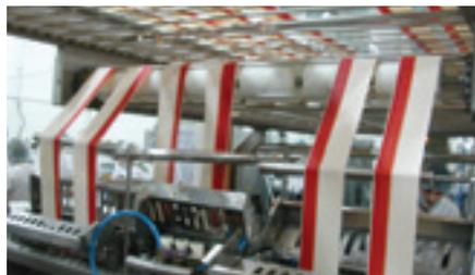
すり身に直接電気を通し、すり身自身の電気抵抗による発熱で加熱するジュール加熱を応用しました。エネルギー効率に優れ、いろいろな原料にも幅広く対応できます。蒸気加熱式の製造ラインもあります。
