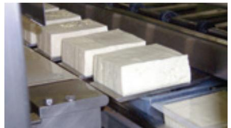
豆乳製造～凝固成形～トレーパックまで連続で一貫製造できる自動ライン。一括集中制御により、熟練した技術を必要とせず、誰にでも味と量目が均一な製品が作れます。また自動化により、衛生対策やコストダウンが可能です。
